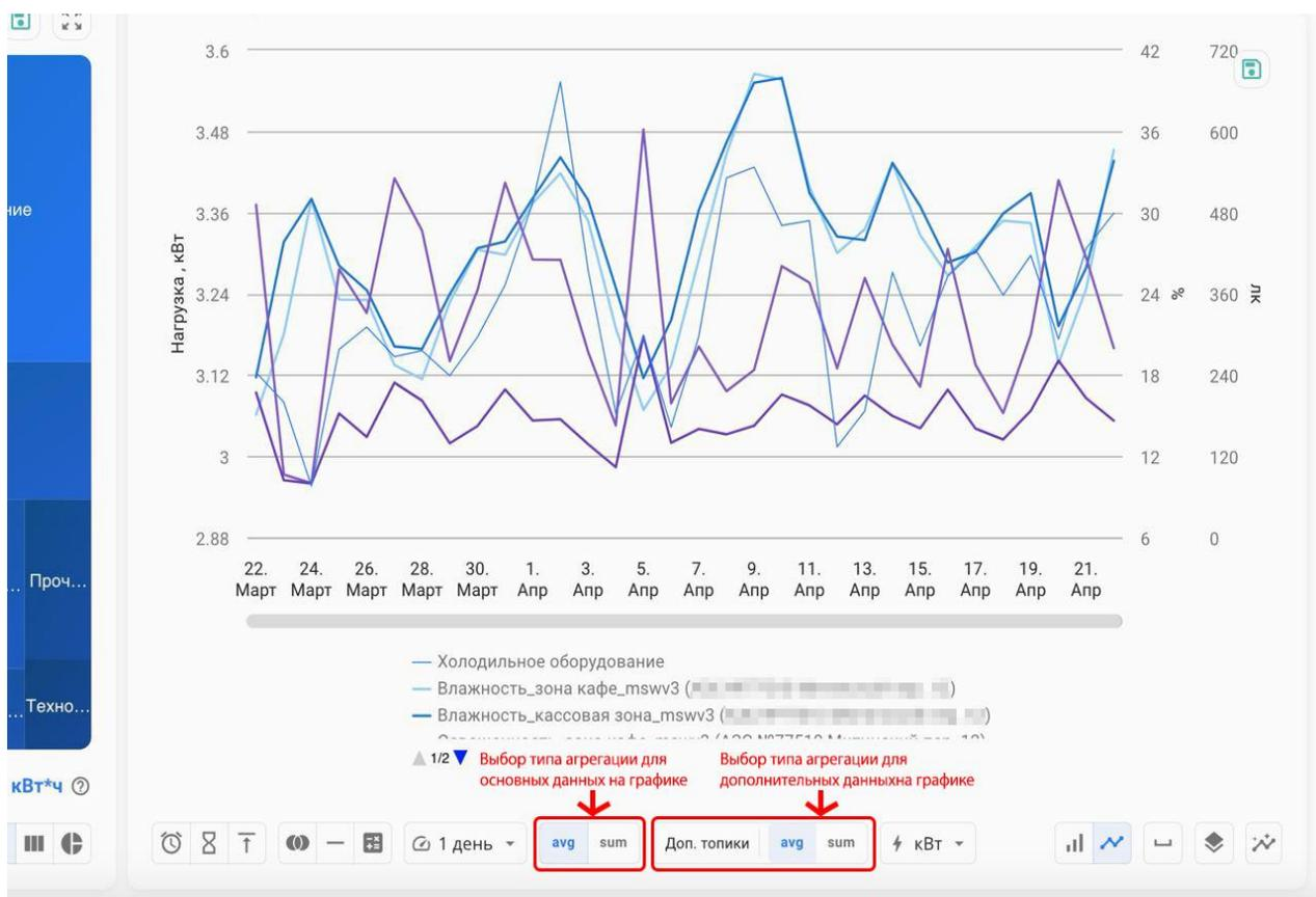
График анализа нагрузки для основных и дополнительных типов данных со средней агрегацией
