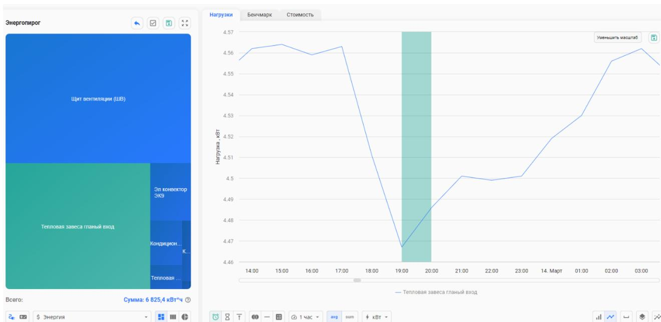
График «разгрузки» потребления в час максимума энергосистемы благодаря работе Дроида - энергоменеджера®
