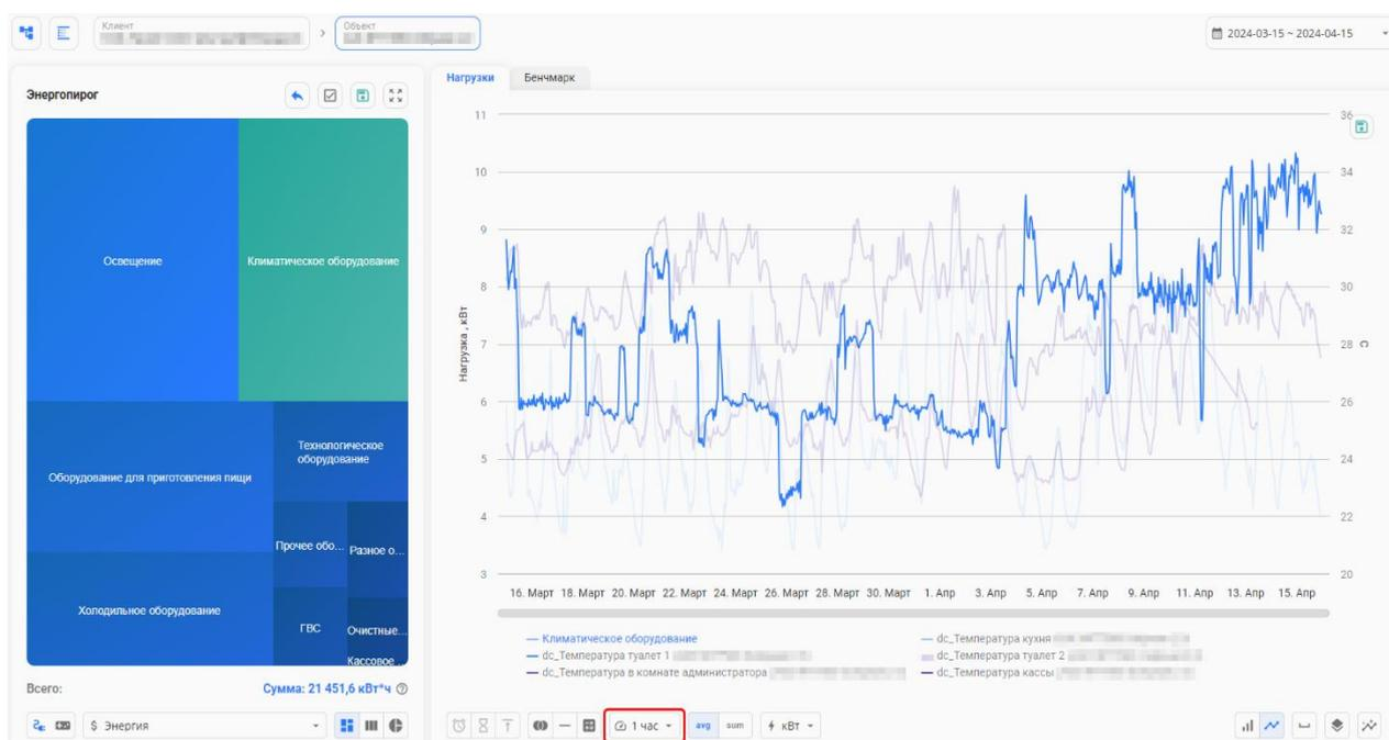
График, с отображением основных и дополнительных видов нагрузки, с использованием среднего типа агрегации для основных типов данных
